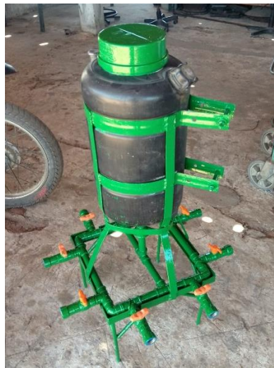
Figura 32: Tanque de amamentação.
