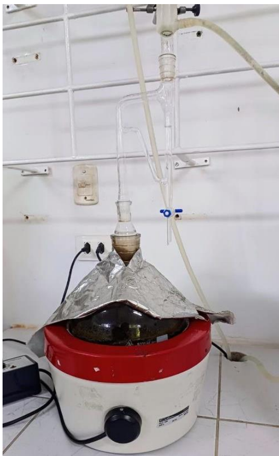
Figura 3. Aparelho do tipo Clevenger modificado.
