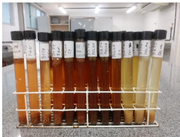
Figura 7 - Amostras em tubo de ensaio submetidas à extração por incubação.
