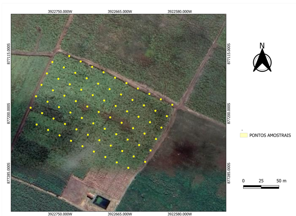
Figura 3: Distribuição georreferenciada dos 60 pontos amostrais no talhão 5 da Estação Experimental de Cana-de-açúcar da UFRPE, com espaçamento médio de 18 metros.
