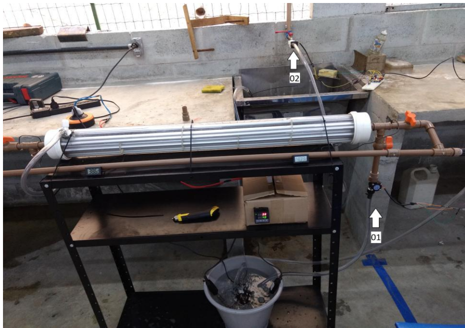
Figura 25 - Posicionamento dos sensores de vazão
