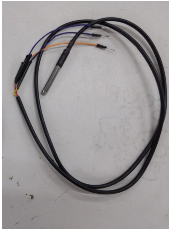
Figura 18 - Sensor de temperatura utilizado com arduíno
