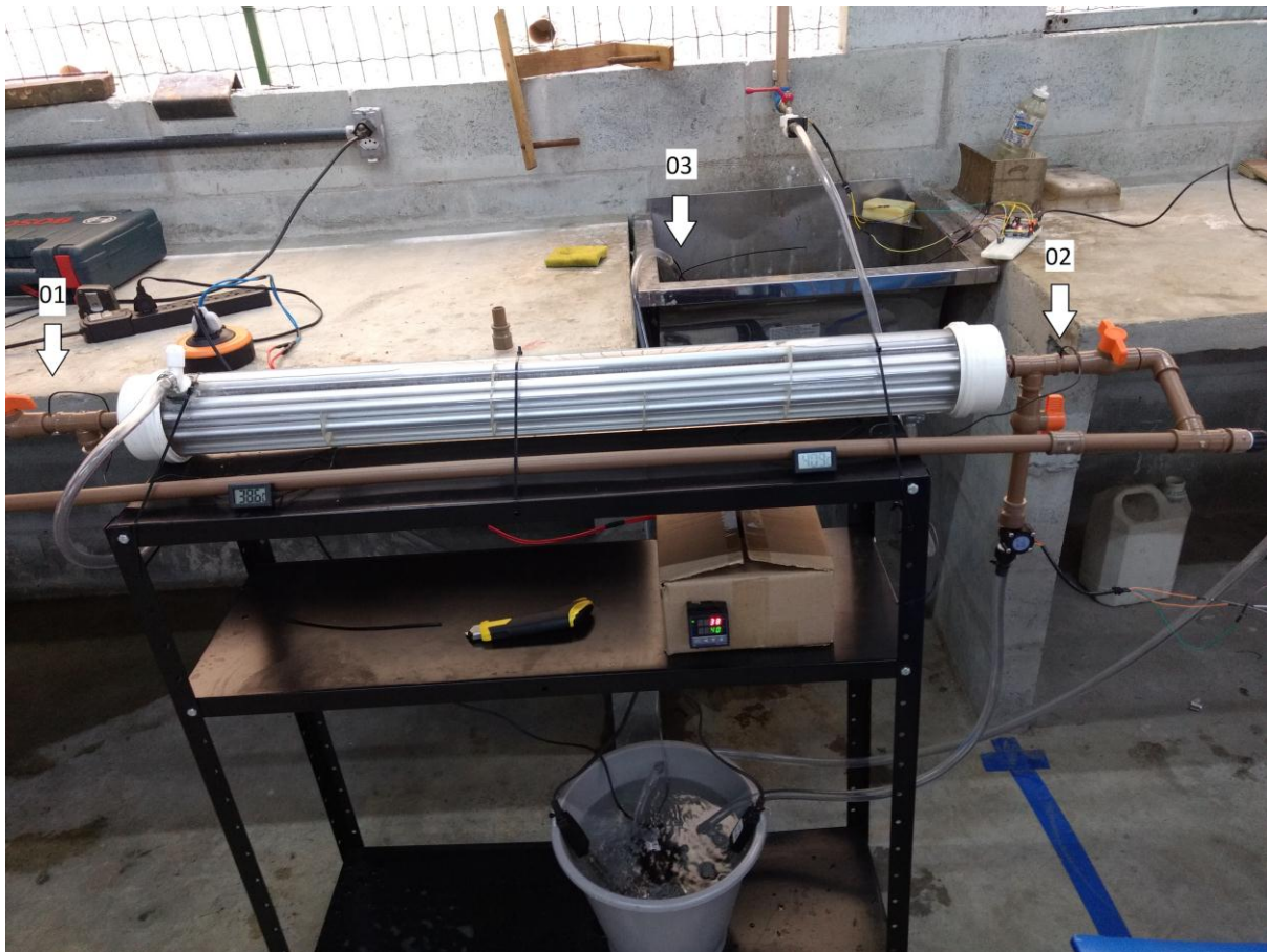
Figura 23 - Posicionamento dos sensores de temperatura
