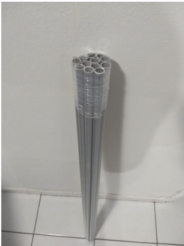
Figura 16 – Tubos do trocador de calor
