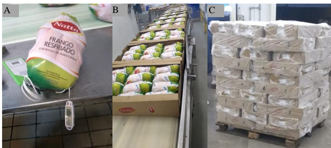
Figura 57- Verificação da temperatura depois de sair do túnel (A) Frango resfriado saindo do túnel (A) paletização (B)
