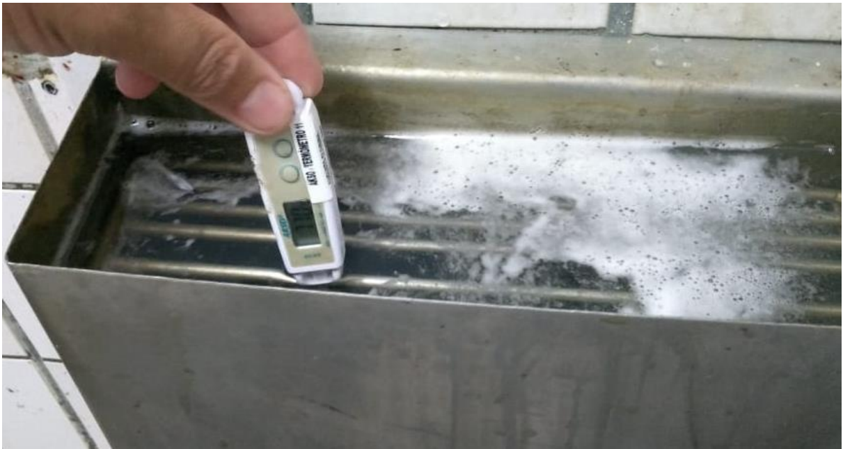
Figura 54- verificação da temperatura do esterilizador
