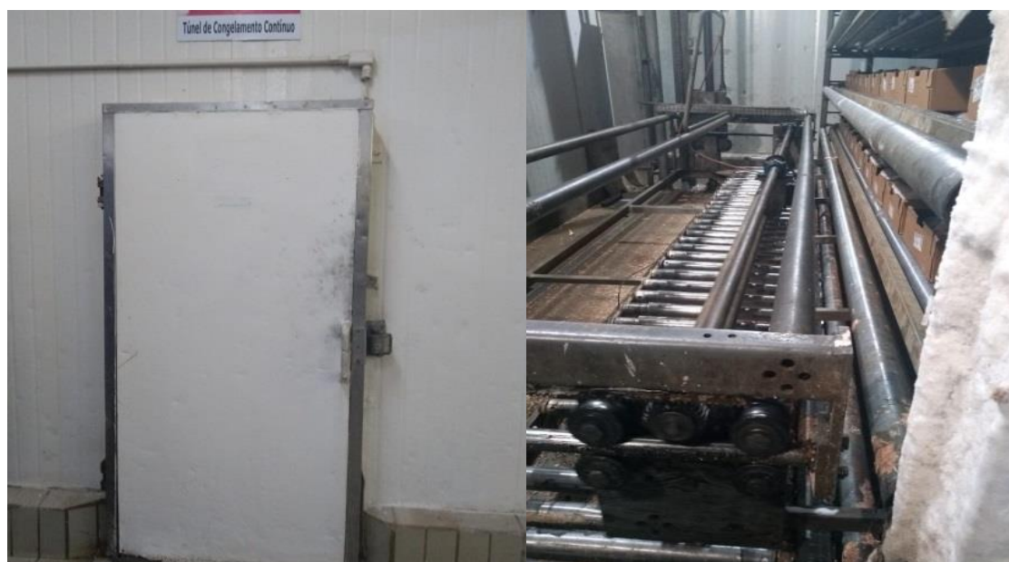
Figura 56- Túnel de resfriamento e congelamento Fonte: Arquivo Pessoal
