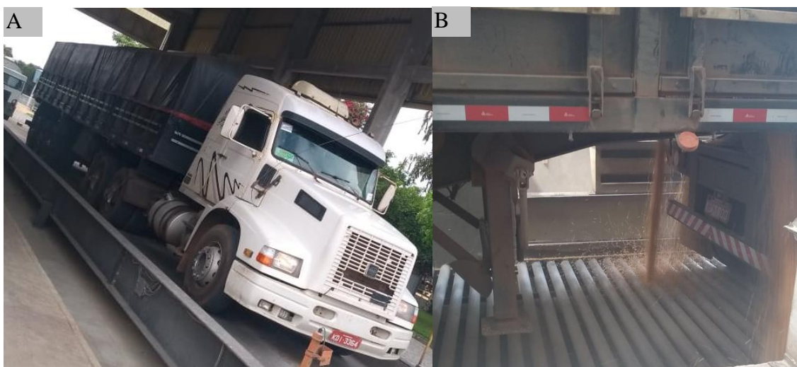
Figura 9- Pesagem do caminhão carregado (A) Descarregamento da matéria-prima(B) Fonte: Arquivo Pessoal
