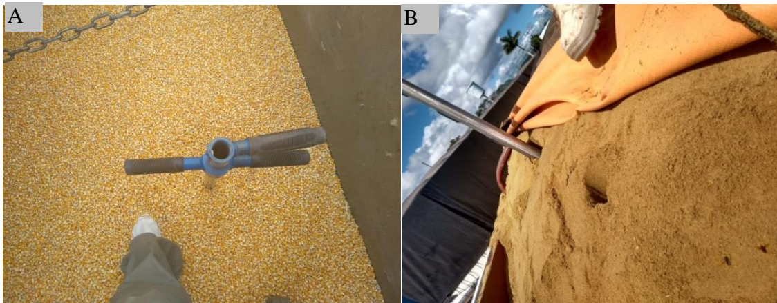
Figura 5 - Coleta de amostras de milho em grão (A) Coleta de amostra de farinha de milho utilizando moinho manual (B)
