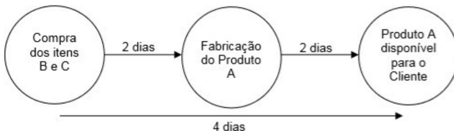
Figura 1: Princípio básico de funcionamento do MRP
