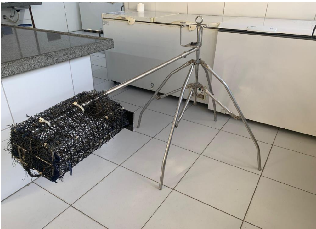
Figura 3 - Estrutura do BRUVS utilizada para observação dos tubarões de galápagos no ASPSP.
