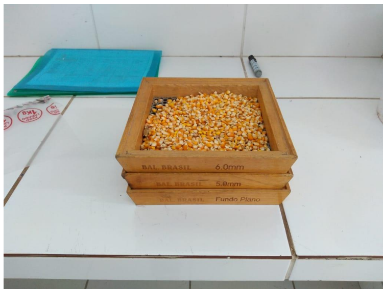
Figura 19 - Peneira para classificação e seleção de grãos.
