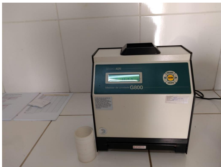
Figura 20 - Medidor de umidade.
