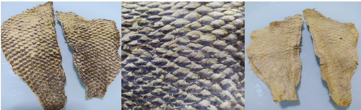
Figura 7: Couro de tilápia utilizando curtimento vegetal com acácia negra: a) Parte externa do couro b) Conservação do desenho da flor da escama pós curtimento c) Parte interna do couro
