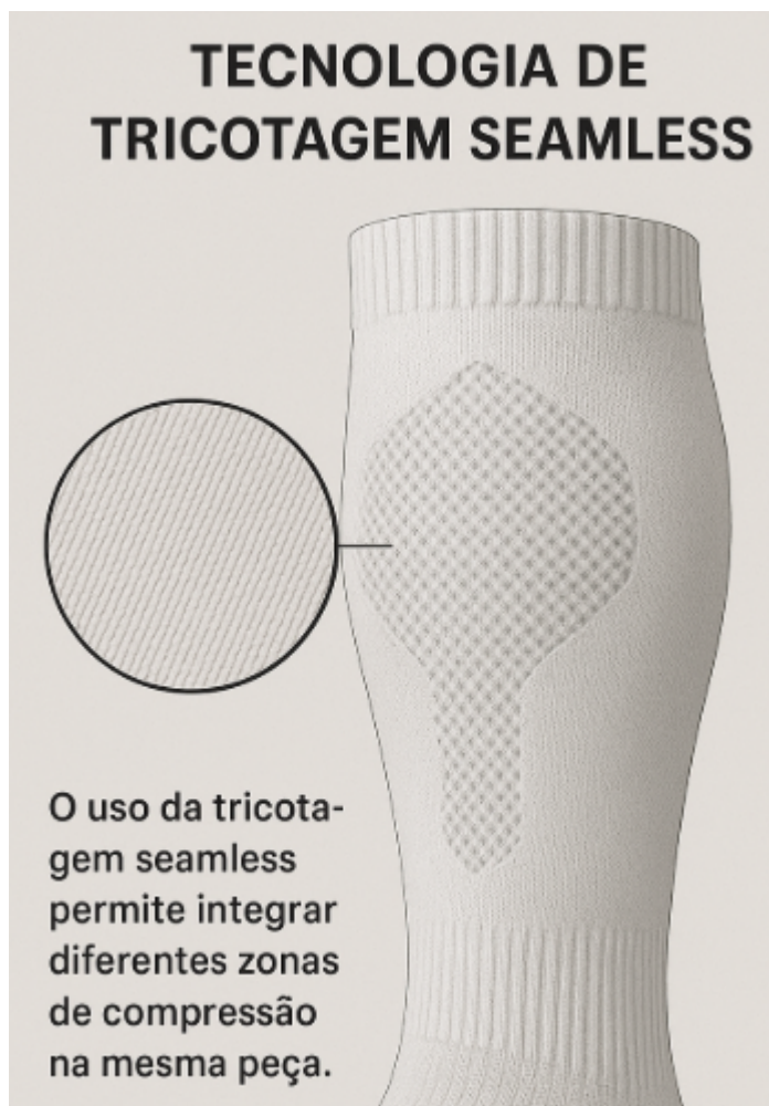
Figura 17 - Representação da tecnologia de tricotagem seamless na região da panturrilha
