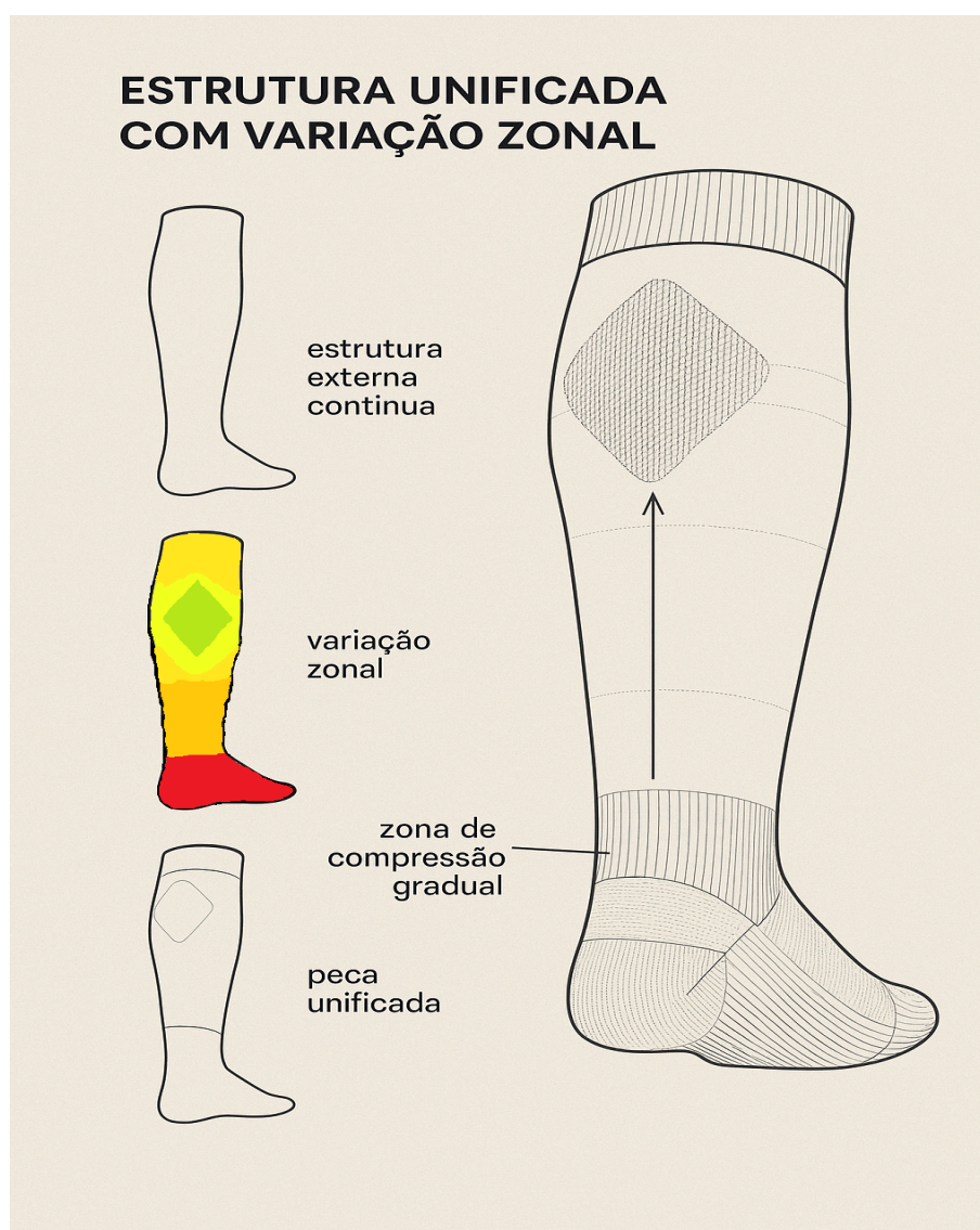
Figura 15 - Ilustração técnica do meião com zonas de compressão diferenciadas.
