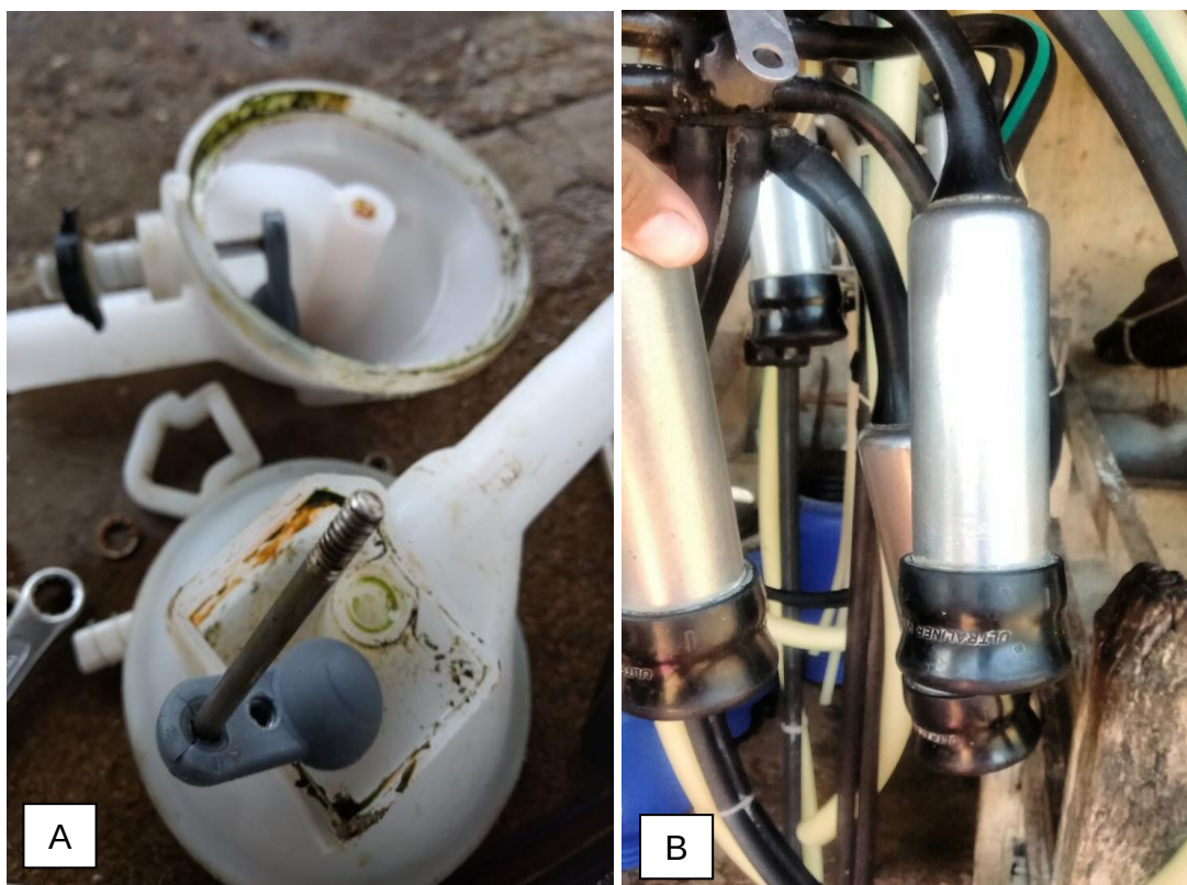
Figura 5: Manutenção de cunho preventivo verificando o funcionamento das diversas partes do equipamento na propriedade Quixaba localizada em Itaíba-PE. Coletor de leite (A), teteiras (B).
