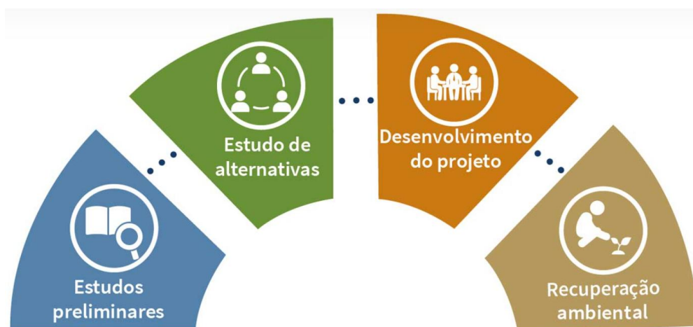
Figura 8: Etapas para o desenvolvimento de um projeto de descaracterização de barragem de rejeito.
