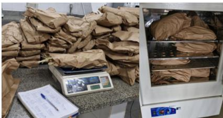
Figura 16. Pesagem e pré-secagem em estufa de 55 °C de genótipos de capim-elefante.
