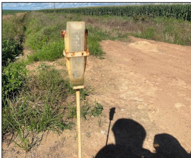
Figura 15. Pluviômetro instalado na borda de um talhão na unidade São Pedro. Foto autoral.
