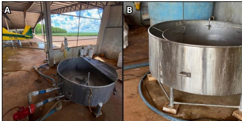
Figura 6. Local do preparo de calda. A) Tanque misturador principal; B) Tanque misturador de apoio. Fotos autorais.
