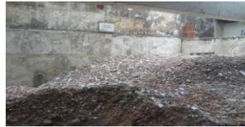
Figura 4 – Agregado miúdo proveniente da britagem dos resíduos
