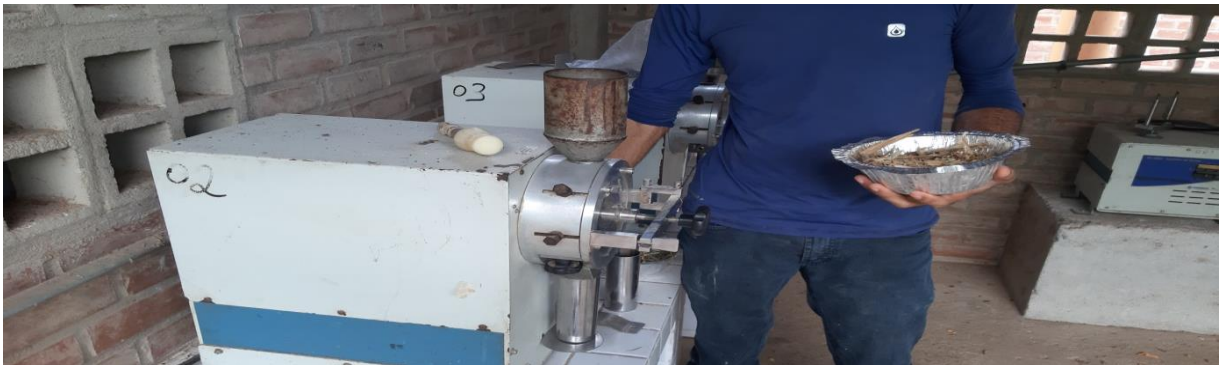
Figura 09: Moinho de facas para análise laboratorial. Fonte: Arquivo Pessoal.
