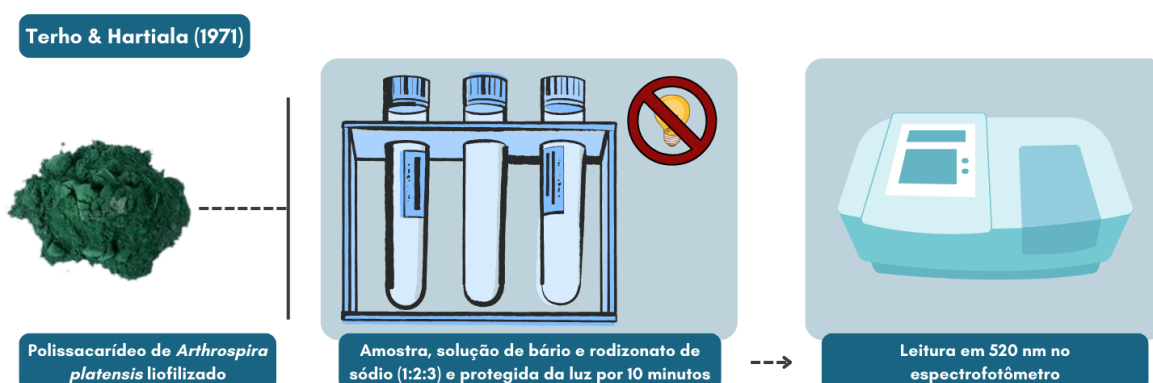
Figura 5 – Metodologia baseada no método rodizonato de sódio para determinação de conteúdo sulfatado.
