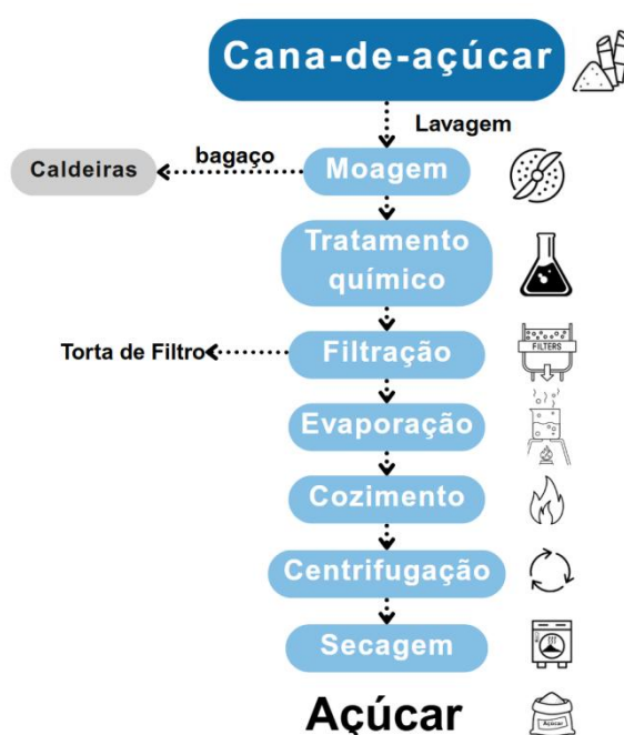
Figura 4 - Processo de produção de açúcar
