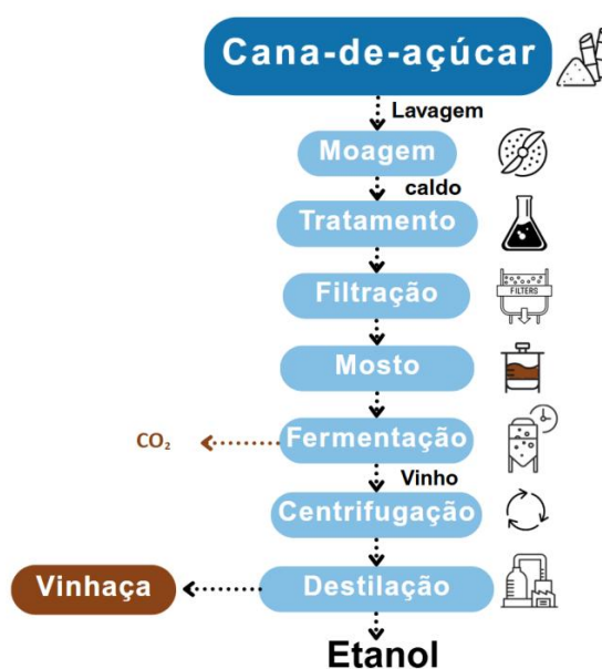
Figura 6 - Processo para obtenção da vinhaça
