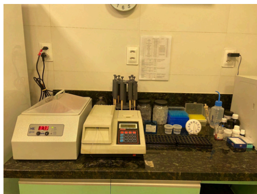
Figura 7: Analisador bioquímico semiautomático Bioplus e Banho maria
