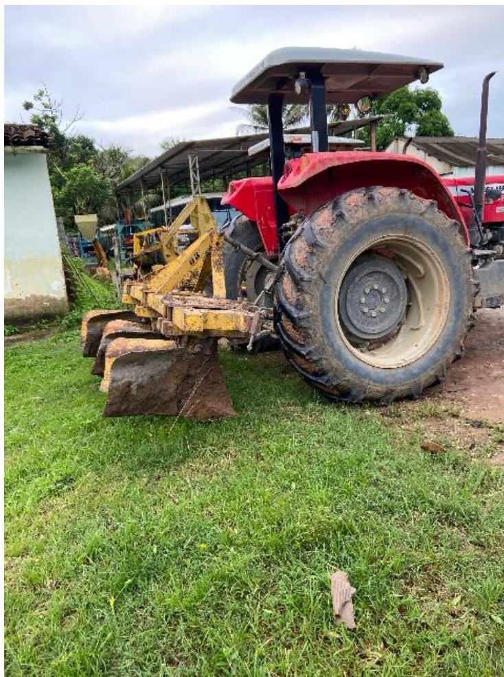
Figura 11: Trator com implemento acoplado (sulcador).
