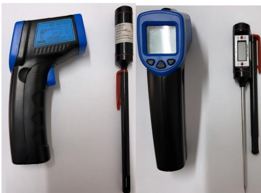
Figura 5. Termômetro infravermelho digital e Termômetro digital tipo espeto Fonte: Arquivo pessoal
