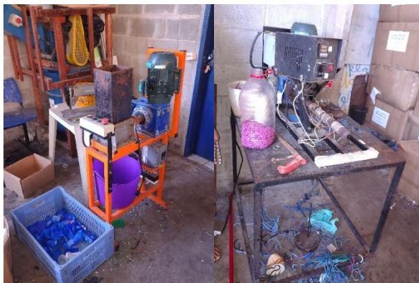
Figura 13. Equipamentos para trituração dos resíduos plásticos e geração de filamentos moldáveis
