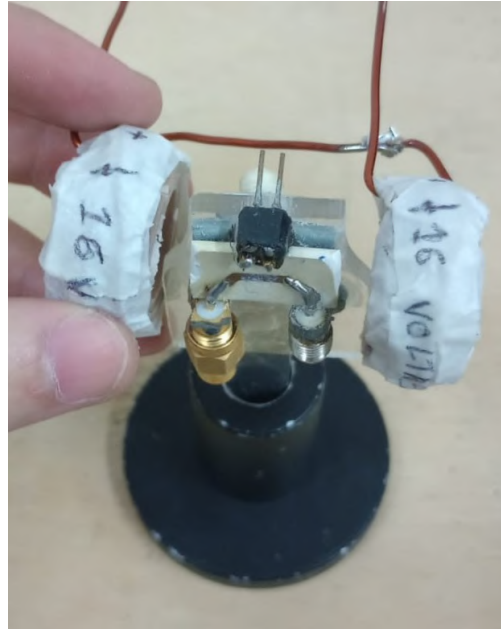
Figura 25 – Bobina não-Helmholtz, posicionada em um suporte para disposição de amostras.
