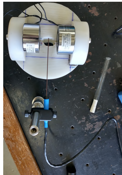
Figura 45 – Vista superior do posicionamento da ponta de prova do gaussímetro.
