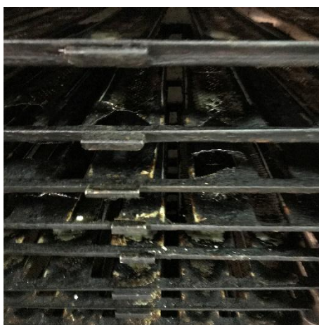
Figura 34: Bandejas para acondicionar pães, quebradas e mal higienizadas.
