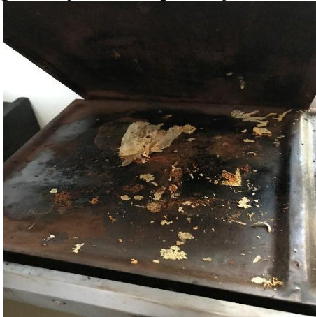
Figura 27: Chapa sem higienização e com presença de ferrugem.
