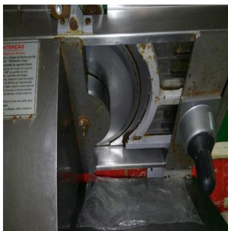
Figura 44: Máquina fatiadora enferrujada e mal higienizada.
