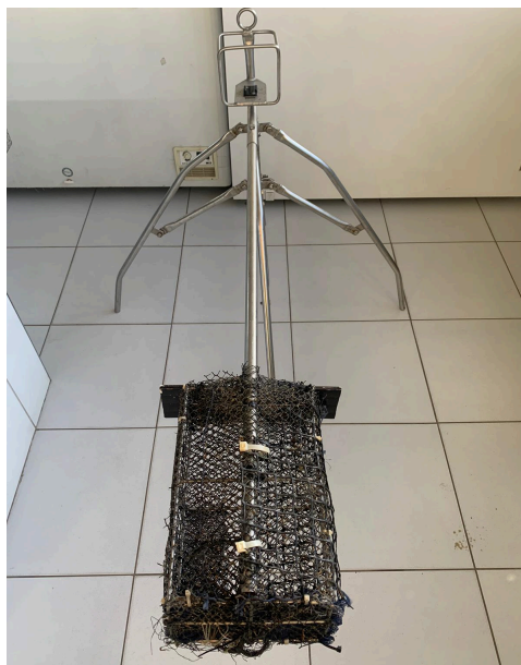
Figura 2 – Estrutura do BRUVS utilizado nas coletas no entorno do Arquipélago de São Pedro e São Paulo.
