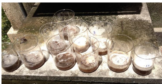
Figura 3. Realização do processo de oxidação avançada para os ensaios com presença de radiação solar.
