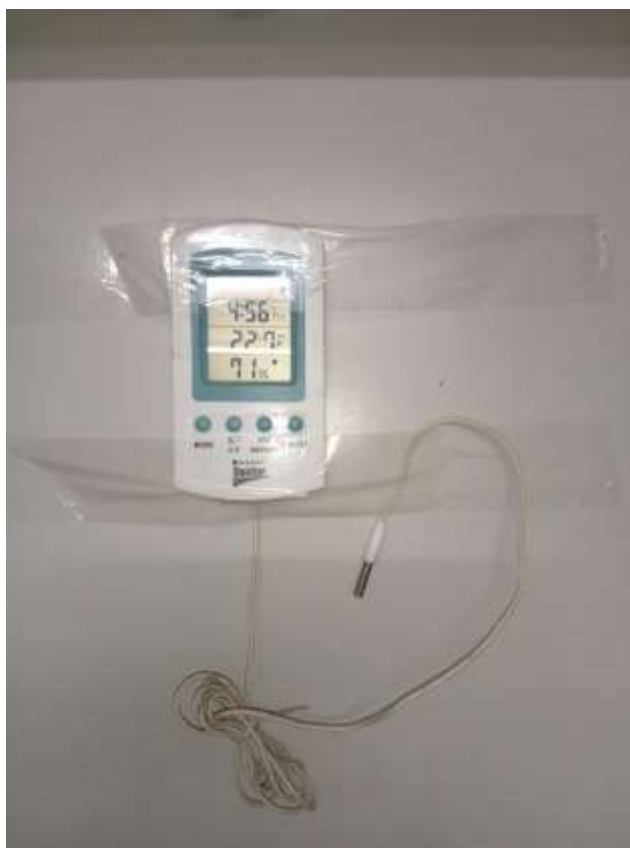
Figura 13 - Medidor de temperatura e humidade na sala de sementes
