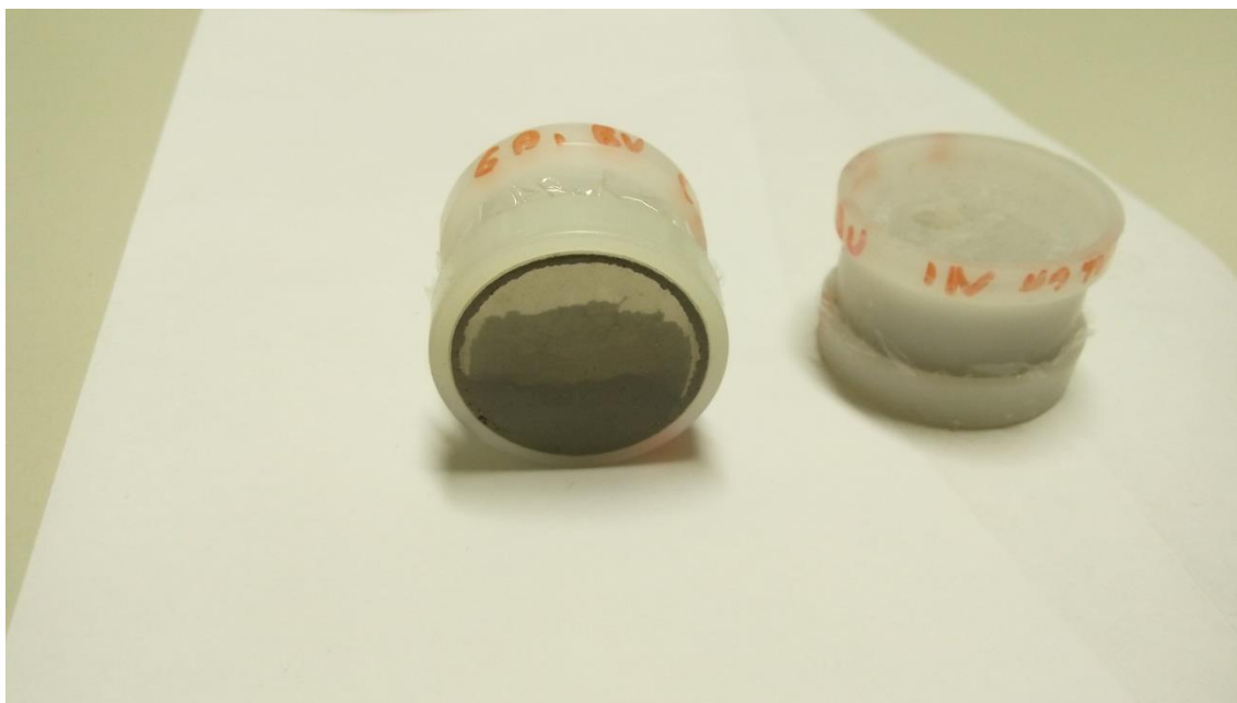
Figura 8: Tubos de polietileno vedados com filme de polipropileno
