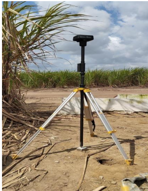
Figura 8-Base GNSS RTK posicionada em um ponto com coordenadas conhecidas
