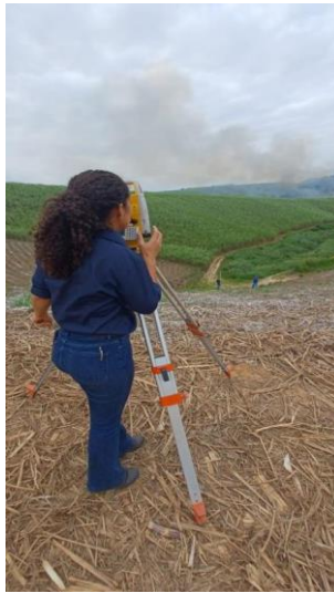
Figura 6-Levantamento planialtimétrico para análise de declividade com estação total
