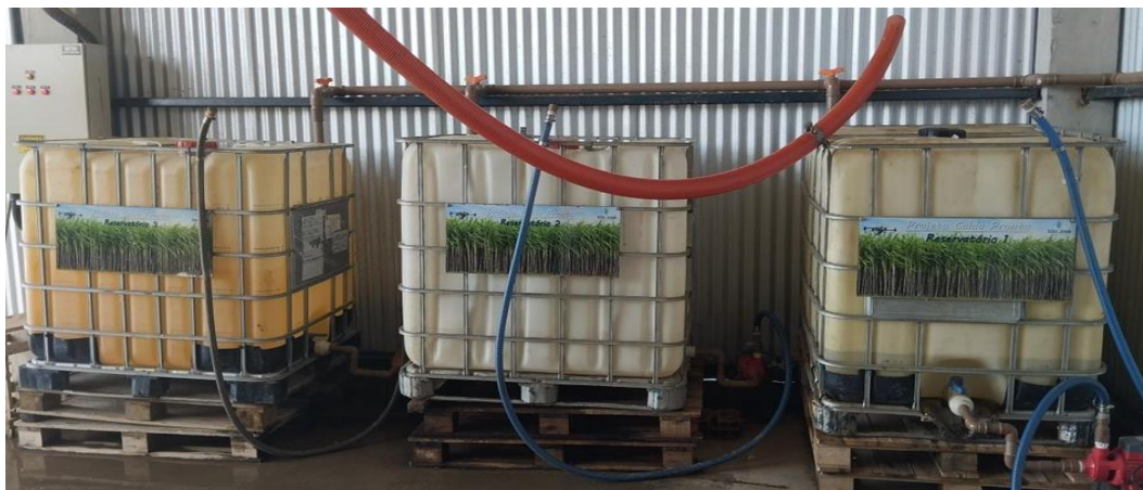
Figura 33-Sistema de preparo da calda com tanques de mil litros do Projeto Calda Pronta
