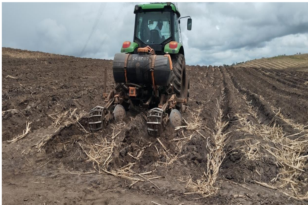
Figura 23-- Trator realizando cobertura mecanizada em área de plantio convencional
