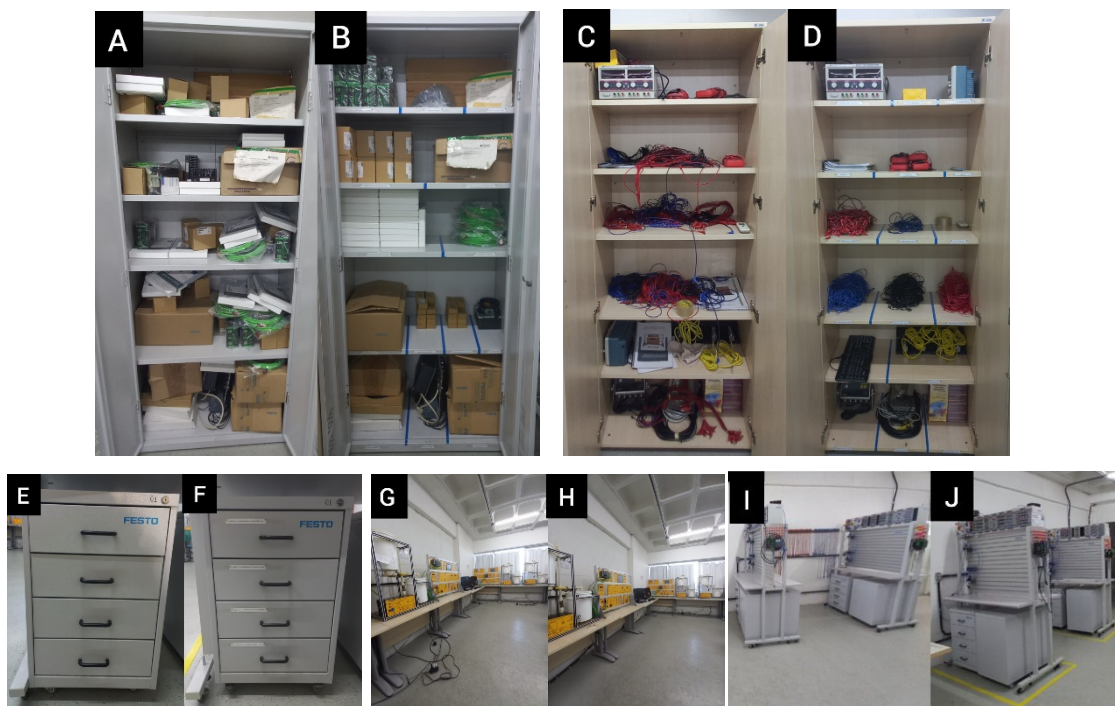
Figura 5 – Organização do armário 2: (a) antes do 5s, (b) depois do 5s; Organização do armário 1: (c) antes do 5s, (d) depois do 5s; Gavetas da bancada: (e) antes do 5s, (f) depois do 5s; Organização dos fios (g) antes do 5s, (h) depois do 5s; Isolamento de equipamentos: (i) antes do 5s, (j) depois do 5s.
