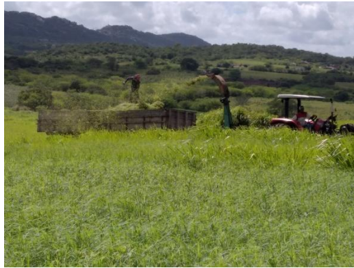
Figura 48: Corte do capim tifton com o uso do trator com ensiladeira e reboque.
