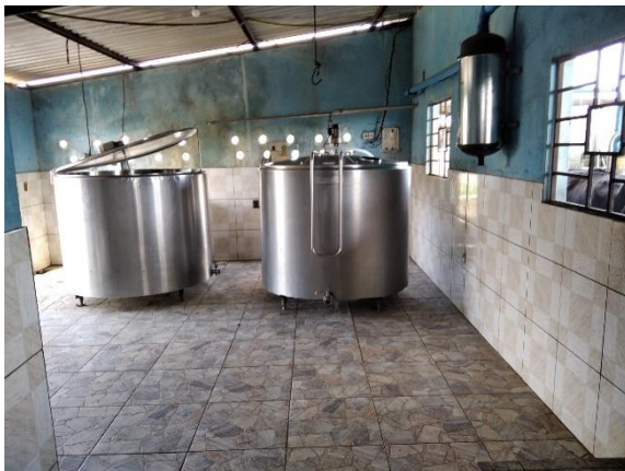
Figura 7: Tanques de resfriamento de leite com capacidade de armazenamento de 2000 litros cada.
