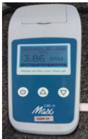
Figura 8: Medidor de cloro
