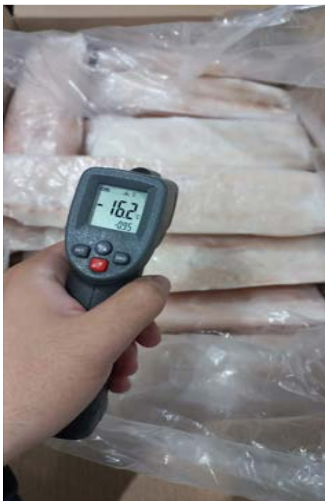
Figura 23: Verificação de temperatura não conforme
