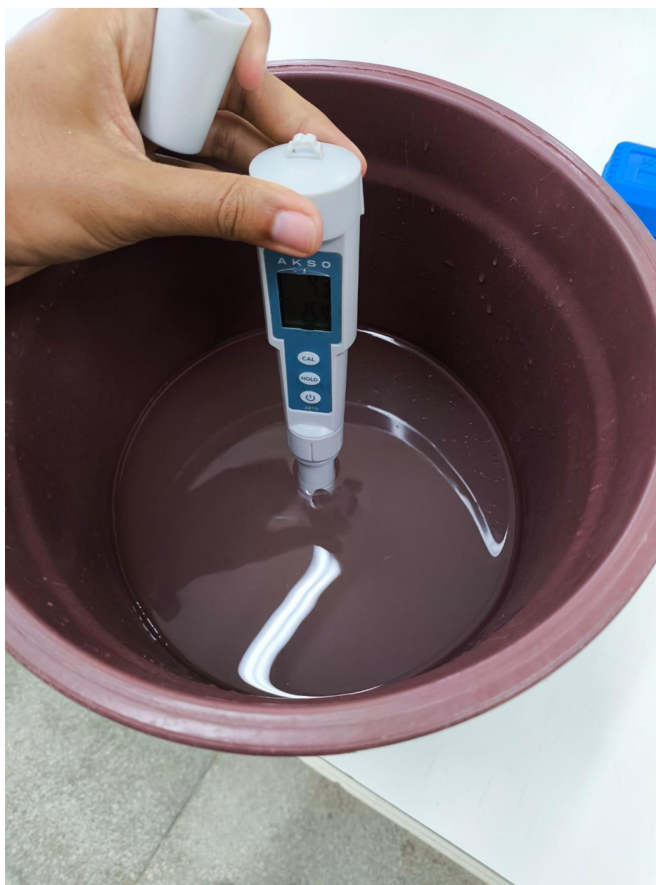
Figura 5 - Realizando medições da solução. (Fonte: Arquivo pessoal, 2024)
