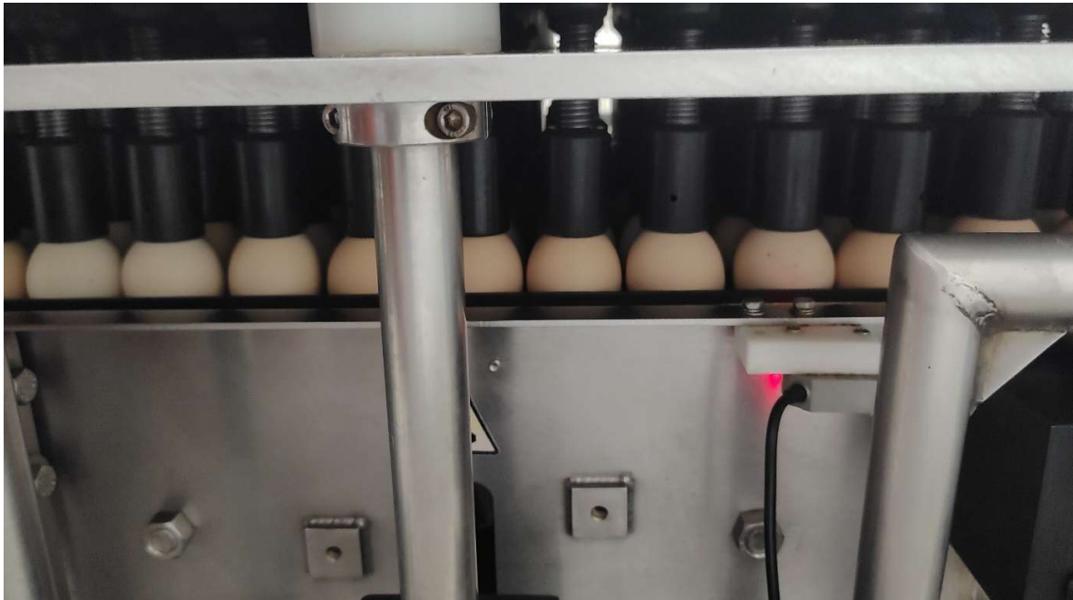
Figura 22 – Vacinação via in ovo de embrionados no 18º dia. Fonte: Arquivo pessoal, 2024 (Autorizado pela empresa).
