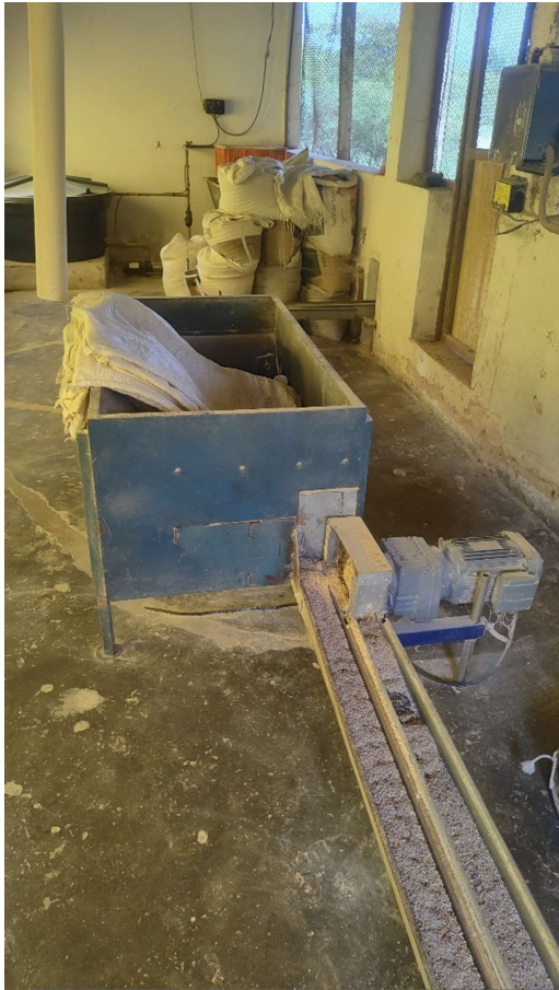
Figura 4 – Equipamento de distribuição de ração de aves fêmeas. Fonte: Arquivo pessoal, 2024 (Autorizado pela empresa).
