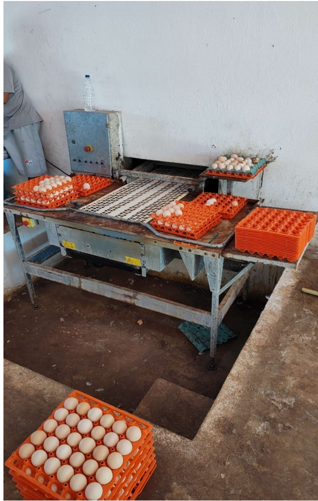
Figura 15 – Saída da esteira de coleta automática dos ovos embrionados no aviário de pressão negativa com ninhos centrais – Visão interna. Fonte: Arquivo pessoal, 2024 (Autorizado pela empresa).
