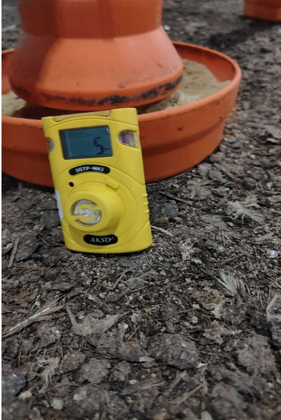
Figura 27 – Equipamento para mensuração de amônia ao nível do solo (cama aviária). Fonte: Arquivo pessoal, 2024 (Autorizado pela empresa).
