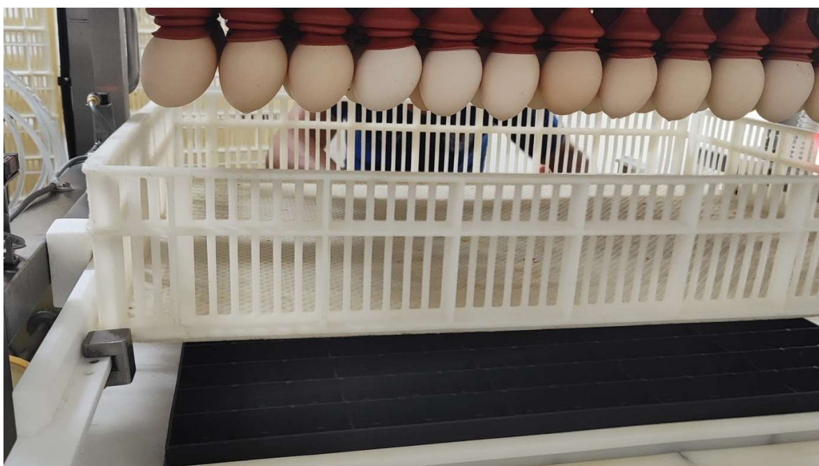
Figura 23 – Acomodação dos ovos embrionados em bandeja de nascimento após vacinação in ovo . Fonte: Arquivo pessoal, 2024 (Autorizado pela empresa).
