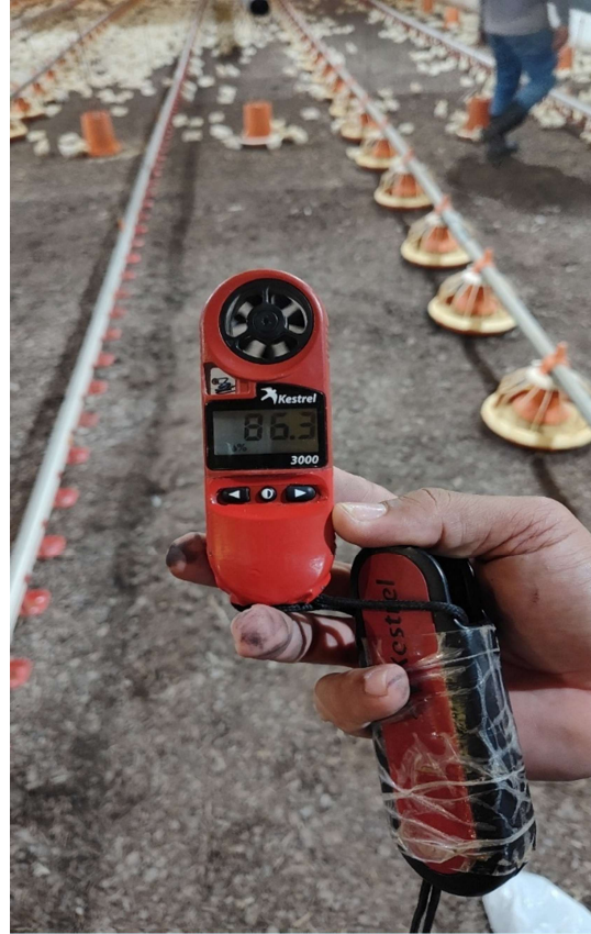
Figura 28 – Equipamento para mensuração da velocidade do ar, temperatura e umidade relativa. Fonte: Arquivo pessoal, 2024 (Autorizado pela empresa).
