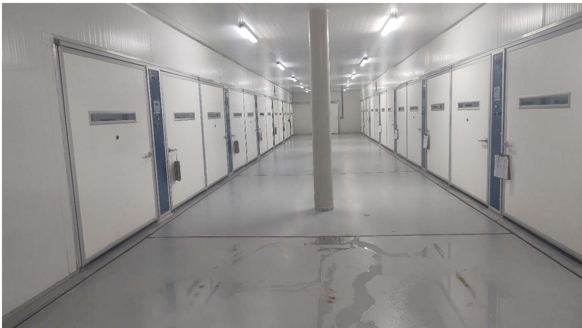
Figura 20 – Máquinas de incubação de estágio único. Fonte: Arquivo pessoal, 2024 (Autorizado pela empresa).
