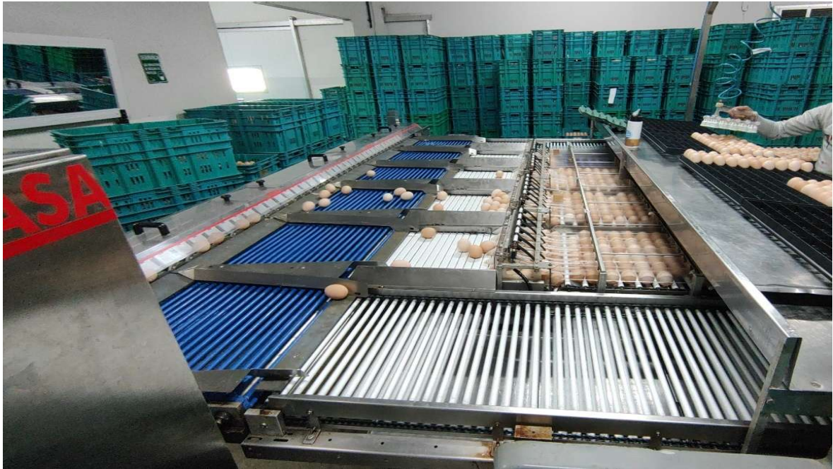
Figura 18 – Esteira da máquina classificadora de ovos embrionados. Ao fundo, caixas de armazenamento de ovos. Fonte: Arquivo pessoal, 2024 (Autorizado pela empresa).
