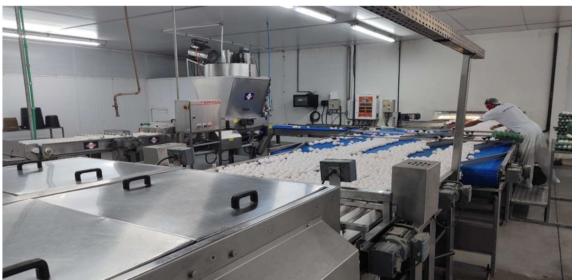
Figura 36 – Esteira de processamento de ovos comerciais. Fonte: Arquivo pessoal, 2024 (Autorizado pela empresa)
