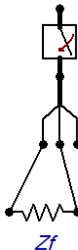
Figura 51 - Curto-circuito bifásico no ATPDraw .
