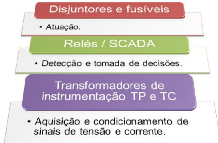
Figura 20 - Estrutura básica de um sistema de proteção.
