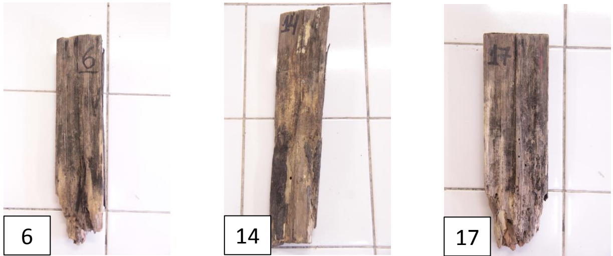
Figura 7. Corpos-de-prova de nº 6, 14 e 17 após deterioração em campo ( Eucalyptus sp. in natura).
