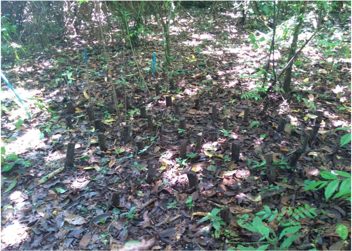
Figura 6. Disposição e local do experimento em campo de apodrecimento.
