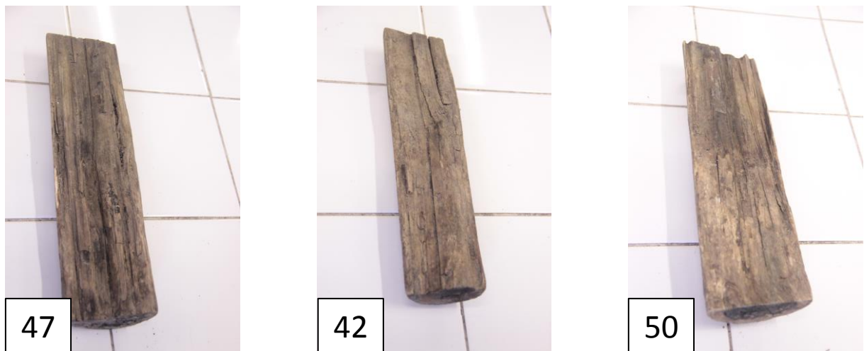
Figura 9. Corpos-de-prova n° 47, 42 e 50 após período de deterioração em campo ( Eucalyptus sp. tratado).
