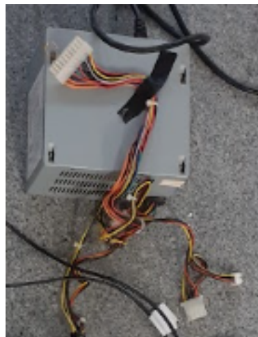
Figura 4.14 – Nesta figura encontram-se a fonte de alimentação ATX utilizada para fornecer energia para os dois NodeMCU e para os coolers.
