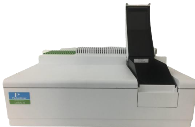
Figura 8. Espectrofotômetro de absorção molecular no UV-Vis utilizado nas análises
