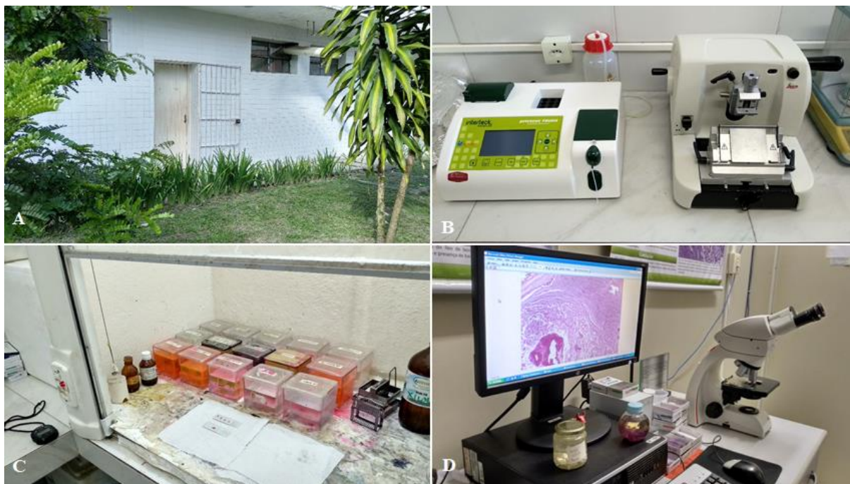
Figura 1 – (A) Área de acesso ao LDA-UFRPE (Recife-PE). (B) Analisador bioquímico semiautomático (esquerda) e micrótomo (direita). (C) Bateria de coloração de lâminas histológicas em HE. (D) Avaliação de lâminas histológicas sob microscopia óptica. Fonte: Silva Filho, 2018.
