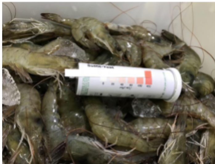
Figura 5: Aferição do teor de metabissulfito através da fita de Merck®.
