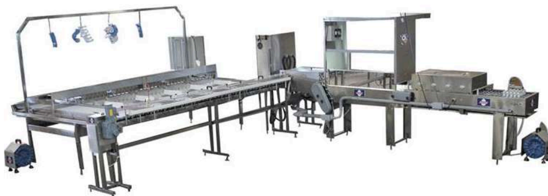
Figura 46. Máquina classificadora por peso automática com ovoscopia.
