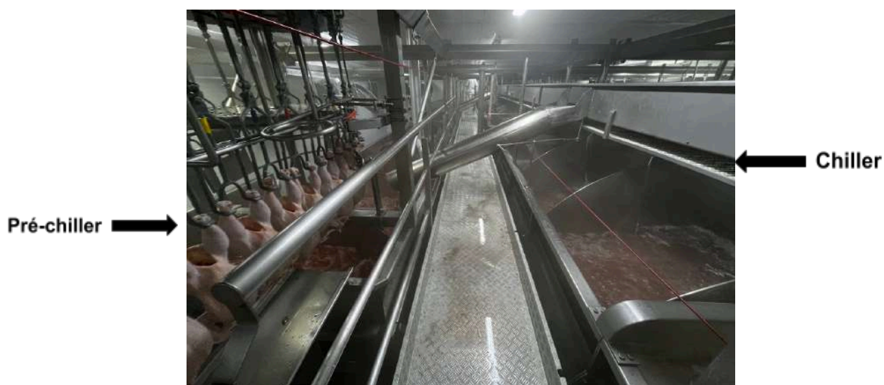
Figura 88. Processo de pré-resfriamento no pré-chiller e no chiller Fonte: Arquivo pessoal
