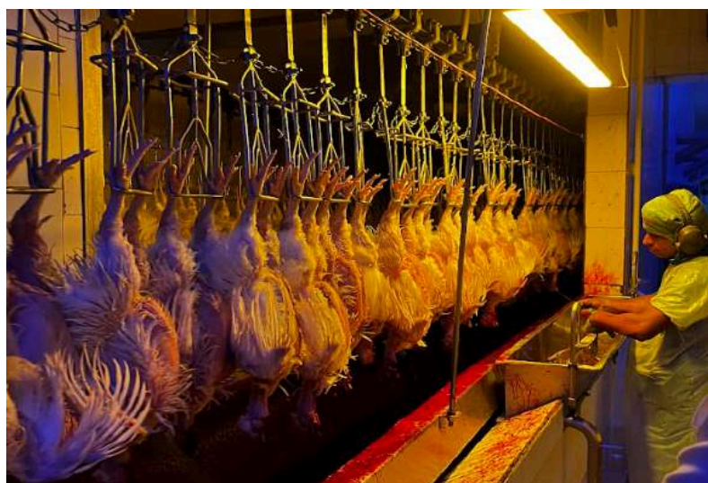
Figura 72. Sangria manual e inspeção do corte automático Fonte: Arquivo pessoal
