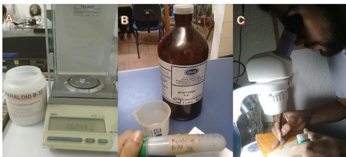
FIGURA 36: A) Pesagem de 0,6g de Paraloid B-72 na balança analítica de precisão. B) Diluição da concentração em 20 ml de acetona. C) Aplicação de Paraloid 3% no espécime fóssil. Fonte: Artur Araújo, (2018).
